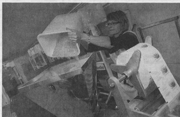
Les bonbons sont broyés, puis les brisures sont versées dans un broyeur en granit permettant d'obtenir une moulure fine. Les brisures sont ensuite versées dans une machine qui soude les petits sachets de 8 gr. Une salariée de la Confiserie met ensuite les sachets dans des boîtes métalliques.
